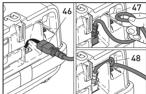
Zur Montage der Anschlussleitung setzen Sie den Kaltstecker (46) in die Buchse ein. Führen Sie die Anschlussleitung anschließend in die Zulentlastung (47) ein, bis es hörbar einrastet. Drücken Sie die Anschlussleitung nun in die Führungsschiene (48) zwischen der Buchse und der Zulentlastung ein.
