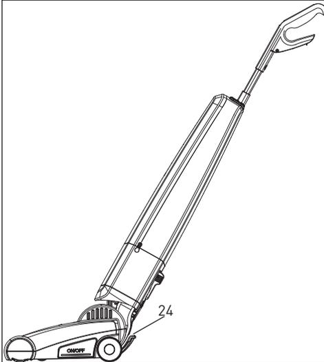
Um den Sauger in die Arbeitsstellung zu bringen, bitte den Griff gut festhalten, das Oberteil kann sonst nach hinten fallen! Zunächst muss das Rastpedal (24) betätigt werden. Danach lässt sich das Oberteil in eine zum Arbeiten bequeme Stellung bringen. Zur Reinigung z. B. unter Möbeln lässt sich das Filtergehäuse weit (bis zu 180°) nach hinten kippen. Der Arbeitsraum wird somit nur durch die Gerätehöhe begrenzt.
