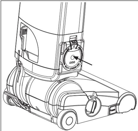
Anschließend die SEBO Power Unit (10) von der rechten Seite in das Gerät einsetzen und so weit einschieben, bis sie deutlich fühlbar und akustisch wahrnehmbar einrastet. Die SEBO Power Unit wird so sicher mechanisch und elektrisch mit dem Gerät verbunden. Die ausführliche Beschreibung der Installation und Entnahme finden Sie weiter unten im Kapitel 8.
