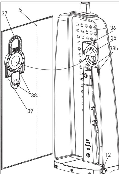
Zunächst die beiden Führungen (38a) der mitgelieferten Filtertüte (5) in die Aufnahmen (38b) im Filterkasten stecken. Dann den Anschluss nach oben schwenken bis der Halter (36) einrastet. Der Anschluss der Luftführung (25) wird dann automatisch mit der Filtertüte verbunden. Bitte beachten Sie, dass die Filtertüte glatt und gerade im Gerät hängt, um maximale Saugleistung und Staubaufnahme sicher zu stellen.
