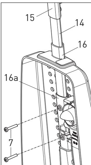
Der Stiel wird von oben durch die Stielführung (16) des Filtergehäuses bis in die Stielaufnahme (16a) eingeschoben und mit den beiden verbliebenen Schrauben M5x30 (7) gesichert
