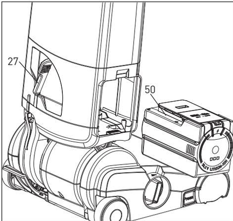
Die SEBO Power Unit sollte jetzt mit beiden Händen vollständig aus der Halterung herausgezogen und auf einer sicheren, tragfähigen Unterlage (z.B. Tisch, Werkbank, o.Ä.) abgelegt werden.
